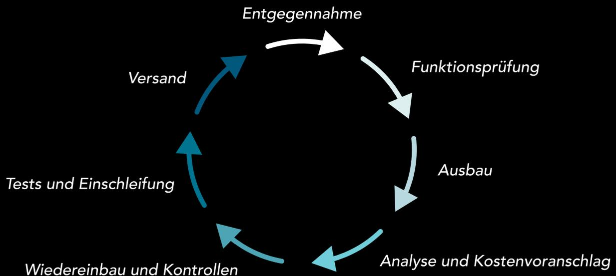
Jede Spindel erhält ein BBN-Zertifikat mit Vibrationssignatur.
